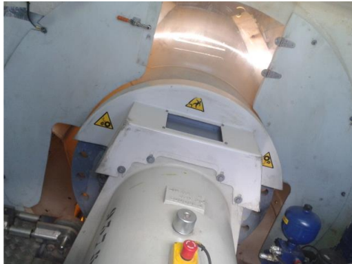
Tren de potencia y buje. A ambos lados pletinas de bloqueo abiertas, sin bloquear. Drive train and hub. Blocking plates in both sides, without function.
